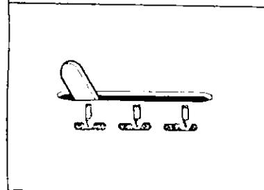
Positione gauche - Utilisez le sélecteur de position d'aiguille et déplacez-le du centre vers gauche.
