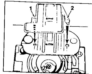
Placez les deux ergots (1) et (2) dans les trous de la plaque à aiguille.
