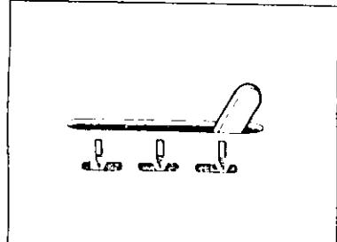
Position droite - Utilisez le sélecteur de position d'aiguille et déplacez-le du centre vers la droite.
