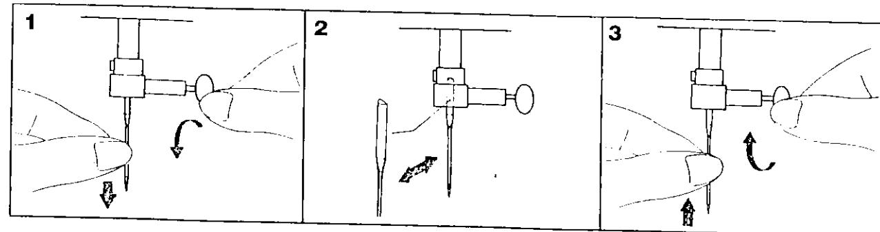
Desserrez la vis et retirez l'aiguille
