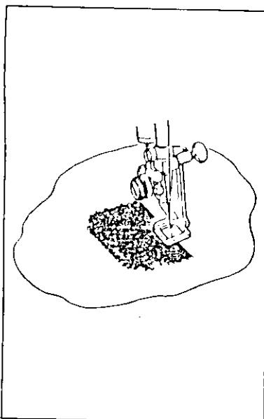
Placez la partie à repriser sous le pied presseur, l'endroit au-dessus.
